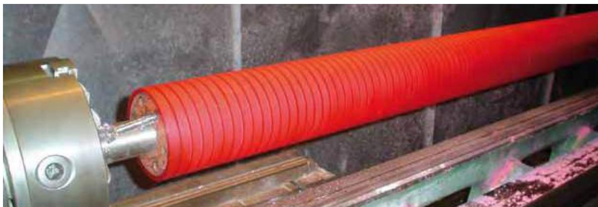
**Polideg** tiene la capacidad y la mejor tecnología para fabricar y recubrir rodillos para toda la industria ofrecemos Entintadores, barnizadores, presores, haladores, exprimidores en formas diferentes como ranurados helicoidales, cónicos entre otros.
